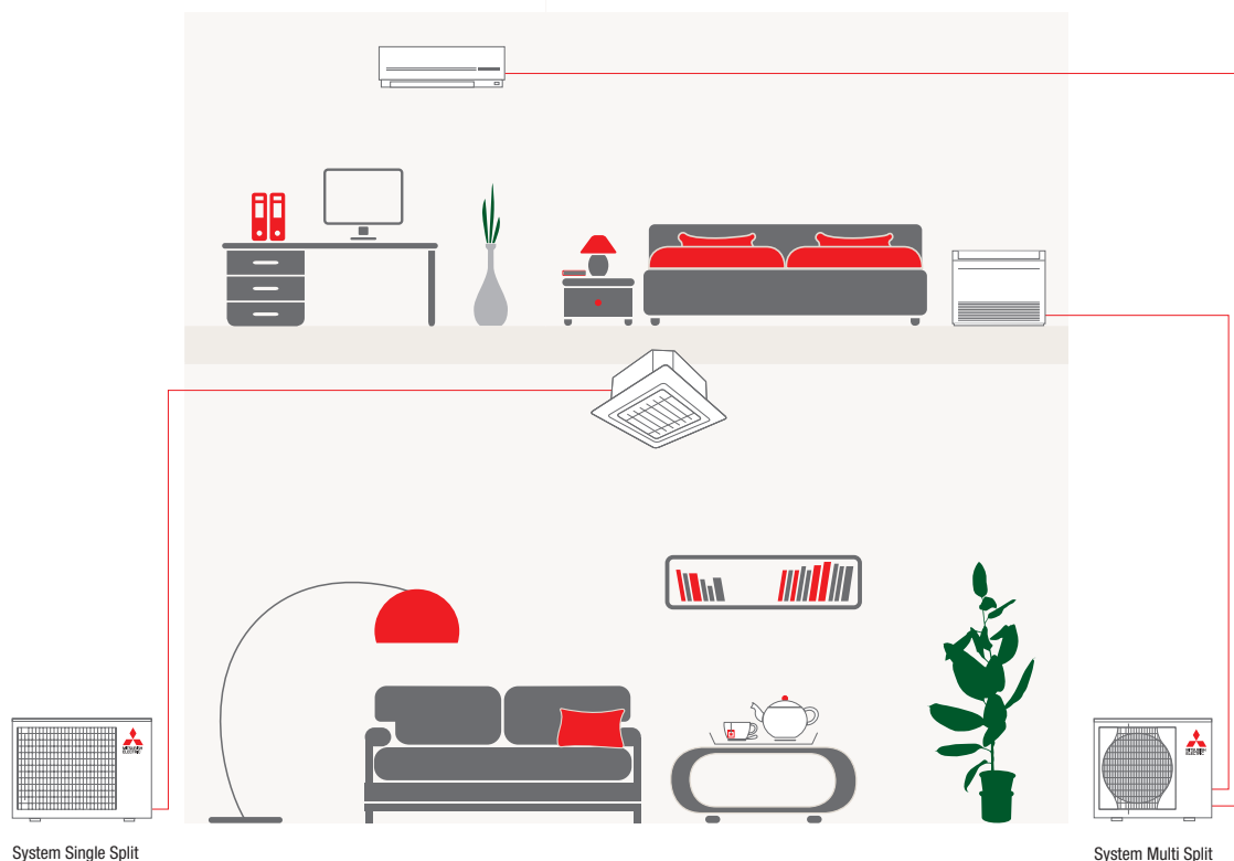
Instalacje Single Split i Multi Split
